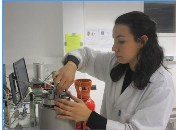
*Fermeture de la cellule et début de test d'étanchéité. Crédit image : Ifremer*
