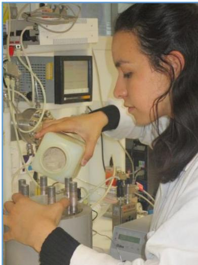
*Introduction de la matrice poreuse dans la cellule haute pression pour l'étude de la formation et la dissolution des hydrates de gaz en laboratoire.
